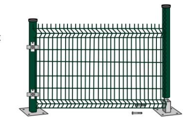
**7** Si se opta por el anclaje con placa base en lugar de cimentación, atornillar la base e insertar el primer poste. Enganchar el panel y colocar el siguiente poste.
