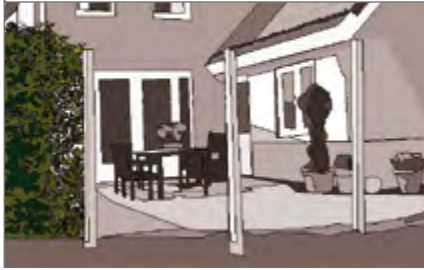
8.20h Colocación de postes
