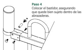
Montaje de bastidor y tramo final
