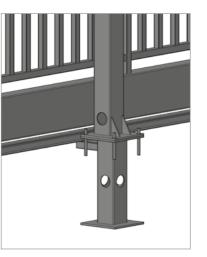
**2.** Con placa base y esperas: sistema de anclaje con placas base y esperas cimentadas.
