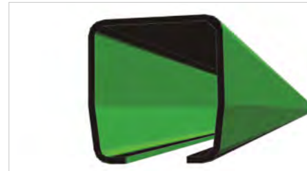
1. Guía inferior: sistema de guía para carros autoportantes que asegura un deslizamiento perfecto de la puerta.
