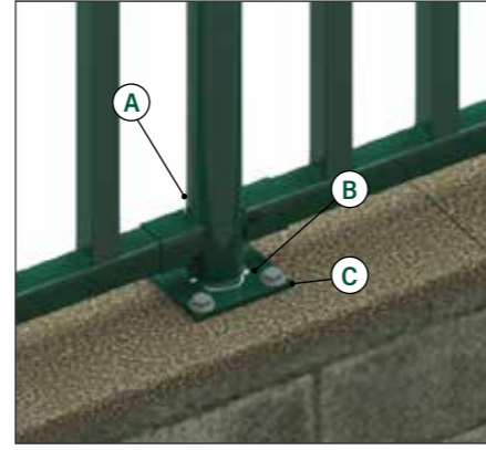
PLATINE Possibilité d'incorporer une platine pour fixer les poteaux sur un mur en béton et sur des clôtures de > 2m00 de hauteur. Dimensions des panneaux 120x120x8mm. A. Poteau clôture Calitax B. Platine C. Ancrage
